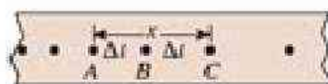
图7.9-2 B点的瞬时速度等于A、C之间的平均速度。
