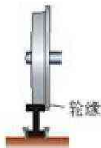
图 5.8-1 火车车轮有突出的轮缘
