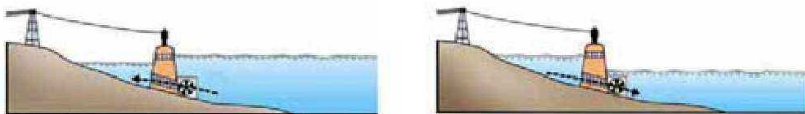
图课-3 潮汐发电的原理
