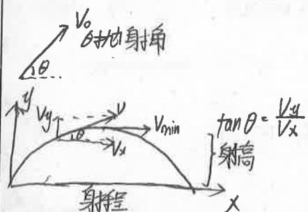
$$\text{射程 } x = \frac{2V_0^2 \sin \theta \cos \theta}{g} \quad \text{射高 } \frac{V_0^2 \sin^2 \theta}{2g} \quad \theta \text{ 为射出角}$$
