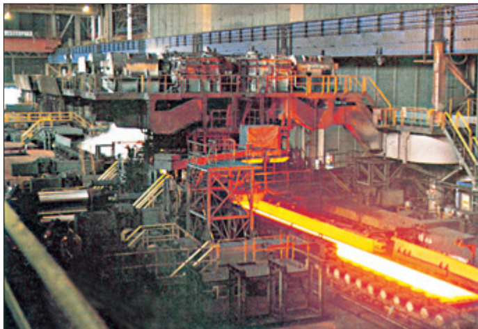
钢铁厂轧钢生产线
