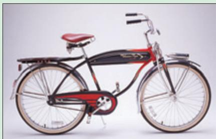
自行车也是由若干基本结构类型组合而成的。其中，车架是框架结构，挡泥板是壳体结构。
