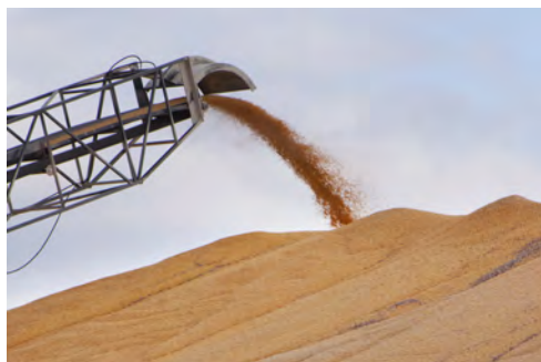
图1-4-4 传送带输送玉米粒
