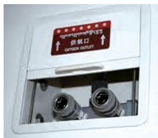
图8-33 青藏铁路车厢内的供氧接口
