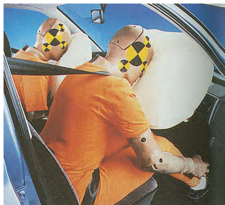
图7-33 采用安全带及安全气囊防护的模拟碰撞实验
