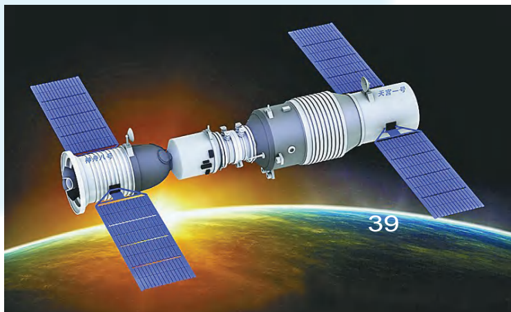
图7-3 “神舟八号”和“天宫一号”对接示意图
