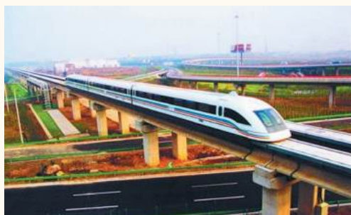
图7.35 磁悬浮列车 上海的磁悬浮列车连接上海市区与浦东国际机场，最高时速为430千米
