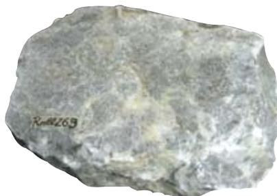
石灰岩以白色、灰色为主，没有矿物晶体结构，遇稀盐酸有气泡反应，可能有化石
