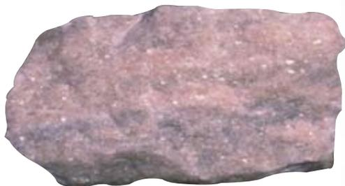
大理岩有矿物晶体结构和片状结构，遇稀盐酸有气泡反应。
