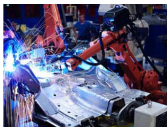
图 5-4-4 这是汽车生产线上的机器人在对汽车车身进行激光焊接
