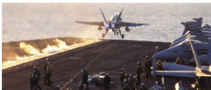
图 4-4-5 在航空母舰上, 飞机的起飞跑道只有 80m ~ 90 m, 仅靠飞机自身的动力无法获得足够的速度实现起飞. 航空母舰利用弹射器对飞机做功, 可以使飞机更快地加速, 从而使飞机在短距离内获得起飞所需的速度飞向天空
