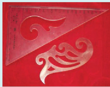
图 2-1-9 你见过绘图用的曲线板吗? 设计师常用曲线板来画某些比较大的弧线
