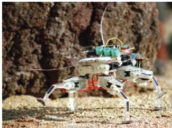
图 2-4-9 美国航空航天局研制出的蜘蛛形机器人将帮助人类对其他星球进行探测，它的每一个动作都是通过轴和齿轮的转动而实现的
