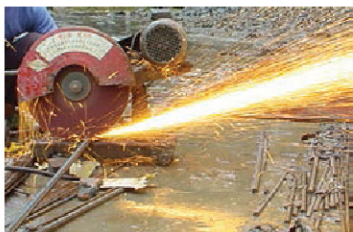
图 1-1-3 砂轮切割钢材时，火花飞溅
