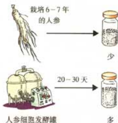
图2-14 人参皂甙的工厂化生产使产量大大增加
