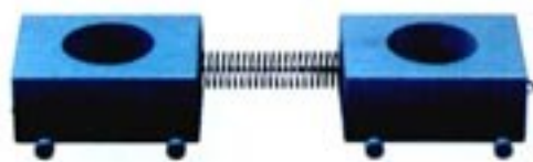
图16.3-4 烧断细线后, 尽管两辆小车都将获得动量, 但它们动量的矢量和仍然为0。
