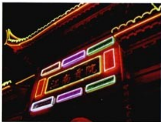
图18.4-3 各种气体原子的能级不同,跃迁时发射光子的能量各异,因此利用不同气体可以制成五颜六色的霓虹灯。
