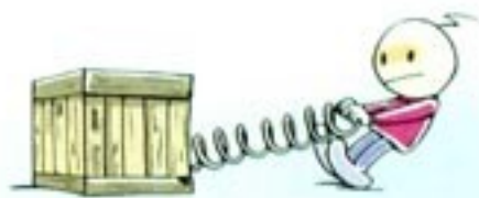
图 16.3-1 图中的弹性势能属于组成弹簧的许多物质单元
