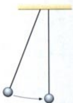
图 16.1-4 通过小球摆起的角度可以知道碰撞时的速度
