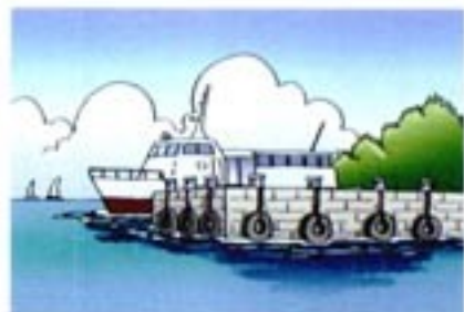
图 16.2-4 船与码头相碰时,旧轮胎能延长船与码头的作用时间,减小作用力。
