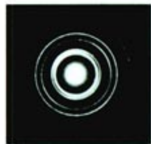
图 17.3-1 电子束穿过铝箔后的衍射图样
