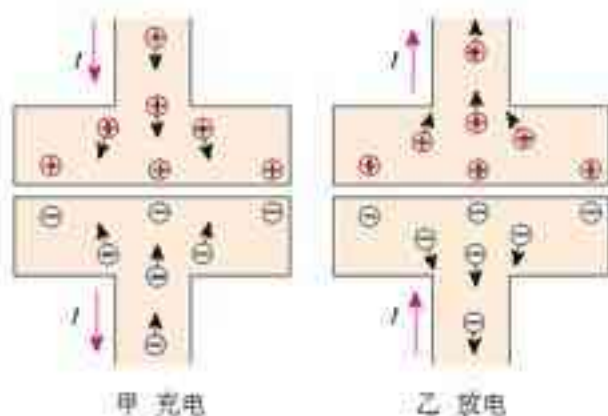
图 5.3-5 电容器充电和放电的示意图
