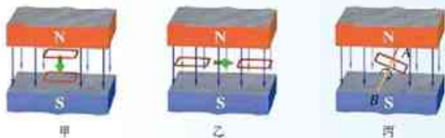
图4.2-8 闭合线框中是否产生感应电流？
