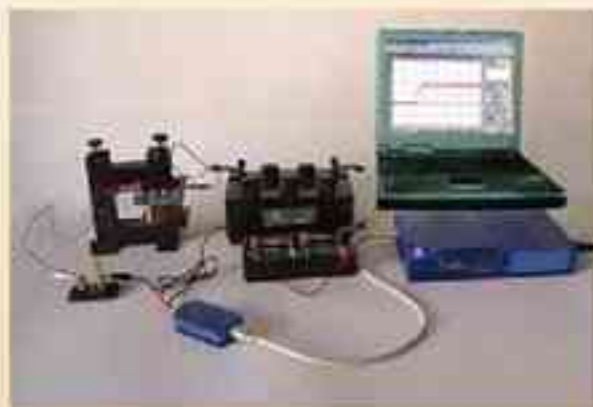
图 4.6-5 显示通电时线圈对电流影响的实验
