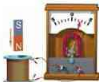
图4.2-2 磁铁插入、抽出或停在线圈中时，电流表指针如何动作？
