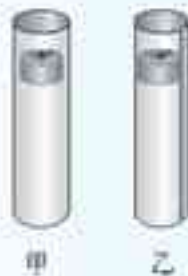
图 4.7-13 铝管不同，磁体下落的速度也不同。
