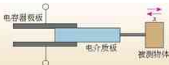
图6.1-8 电容式位移传感器
