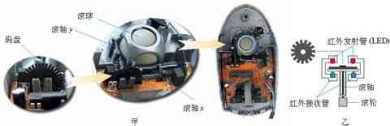
图 6.3-4 机械式鼠标器的主要结构
