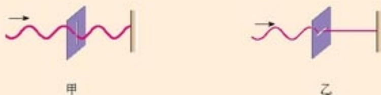
图 13.6-1 横波可能有不同的振动方向
