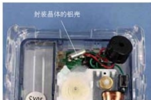
图14.2-4 石英电子钟的振荡器里用的晶体
