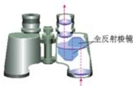
图13.7-5 双筒望远镜中的全反射棱镜
