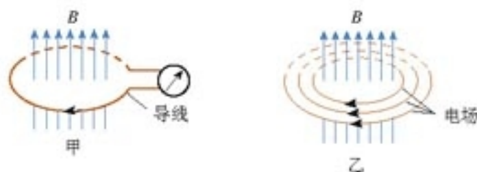
图 14.1-1 变化的磁场产生电场
