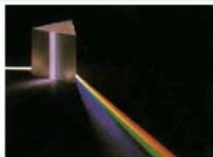
图 13.4-9 光在折射时发生色散的示意图
