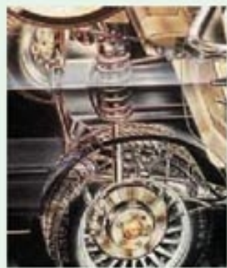
图11.5-6 汽车的减振系统
