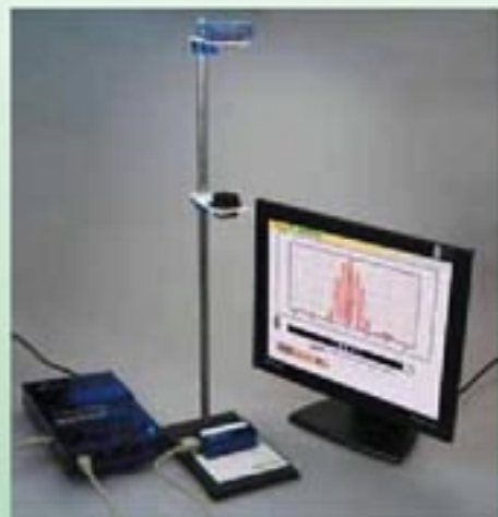
图 13.3-6 用传感器和计算机观察双缝干涉的实验装置
