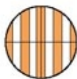
图13.3-5 分划板中心刻线应与条纹的中心对齐
