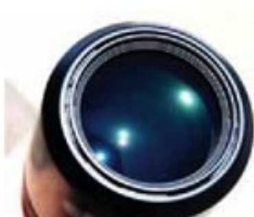
图13.4-5 镜头玻璃的颜色也是光的干涉造成的
