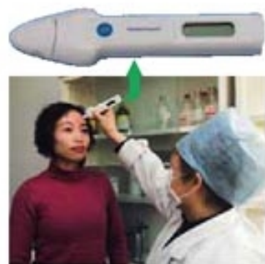
人体在发射红外线，体温越高，发射的红外线越强。根据这个原理，红外体温计不与身体接触也可以测体温。
