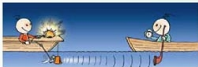
图 12.3-4 第一次测定水中声速的示意图
