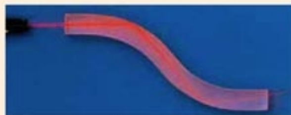
图 13.7-6 弯曲的丙烯树脂棒能导光
