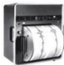
图 11.1-6 绘制地震曲线的装置
