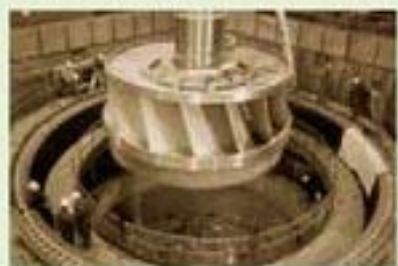
图3.3-11 水轮机中的叶轮，在水电站中用它带动大型发电机。
