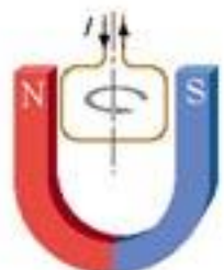
图2.3-5 通电线圈在磁场中受到安培力会扭转，电动机就是根据这个原理设计的。
