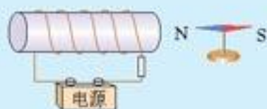
图2.2-7 判断电池的正负极
