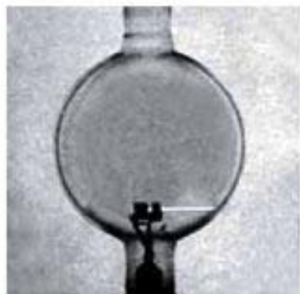
甲 没有磁场时电子束沿直线运动。
