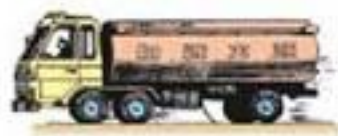
图1.3-2 汽车拖的铁链能把电荷导入大地
