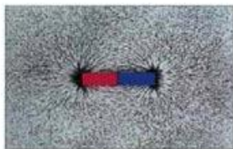
图2.1-6 条形磁体磁感线模拟图
