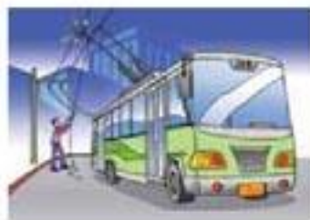
图3.6-1 自感使电车拾电器产生电火花
