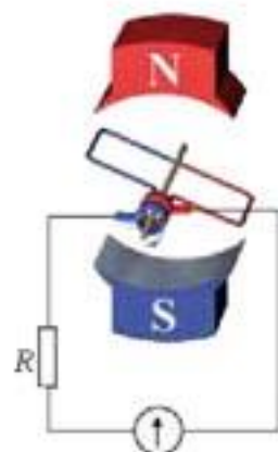
图3.3-1 线圈转动时，穿过线圈的磁通量发生变化，线圈中产生感应电动势。
