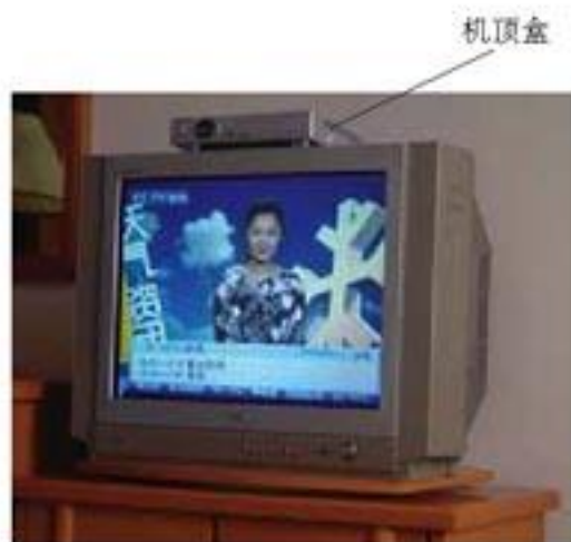
图4.4-10 模拟电视机加一个“机顶盒”就能接收数字电视信号
