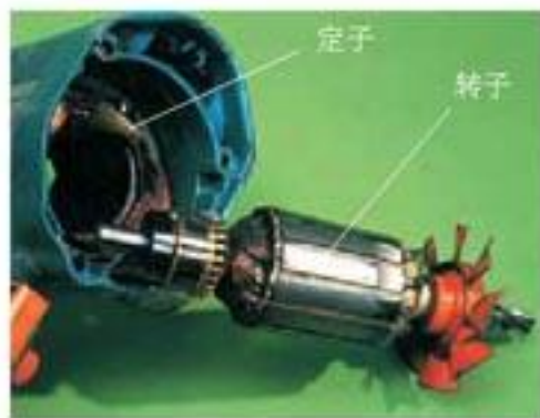
图2.3-6 一种电动机的定子和转子
