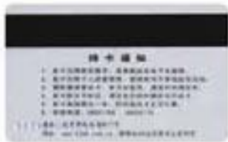
图2.5-5 磁卡。背面的黑条是用做磁记录的磁条。
