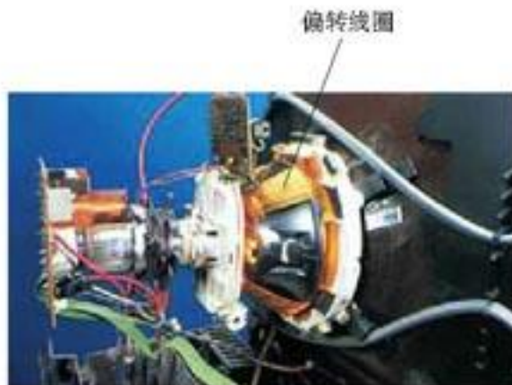
图2.4-5 显像管颈部的偏转线圈
