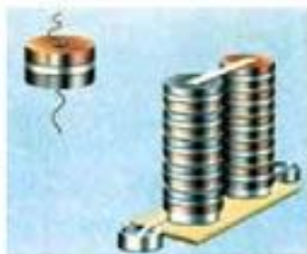
图1.5-2 伏打电堆：在锌片和铜片之间夹上浸透了盐水或碱水的厚纸、布片或皮革，再把几十个这样的单元叠置起来。
