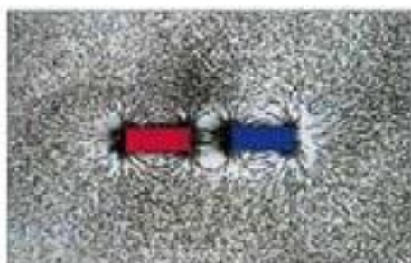
图2.1-6 条形磁体磁感线模拟图
