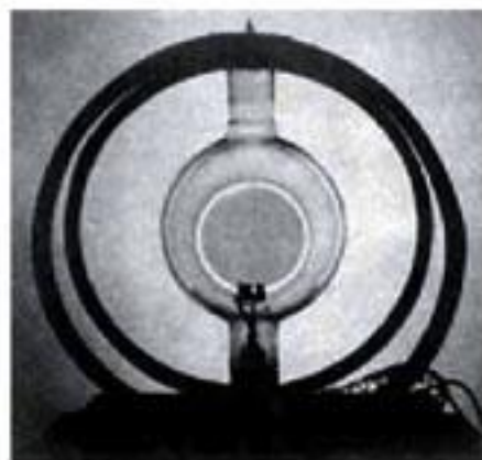
乙 施加垂直于纸面的磁场后，电子束沿圆轨道运动。
