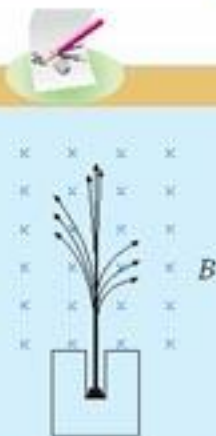
图2.4-8 放射性射线在磁场中分裂为3束
