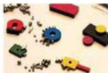
图2.5-3 多种形状的永磁体。它们是用硬磁性材料制成的。
