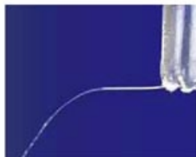
图 5.3-2 喷出的水柱显示了平抛运动的轨迹
