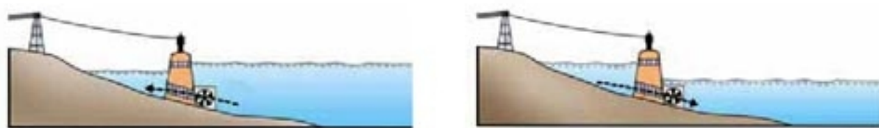
图课-3 潮汐发电的原理
