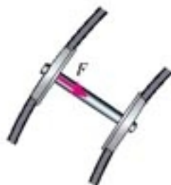
图5.8-2 如果两轨高度相同，外轨作用在轮缘上的力 F 是使火车转弯的向心力。
