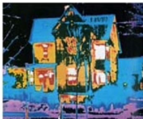
图 7.10-1 一座房屋的红外照片（红外照片是不能分辨颜色的，图中的颜色是为区分不同的温度而在照片处理时加上的）。可以看出，由于取暖和使用电器，室内温度比室外高。热量散失到室外后，不能回收重新利用。
