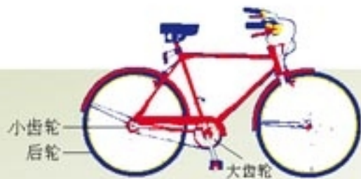
图 5.5-2 自行车的大齿轮、小齿轮、后轮中的质点都在做圆周运动。哪些点运动得更快些?
