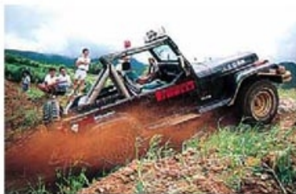
图 7.3-2 汽车爬坡时必须使用低速挡
