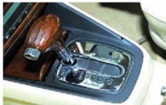
乙 有些汽车的转速比可以根据车速自动改变，但司机也能通过这个操纵杆进行干预。
