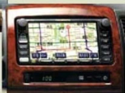
图 6.5-7 国产车载 GPS 根据卫星信号确定汽车位置，利用电脑储存的电子地图，用语音向驾驶员提出建议。
