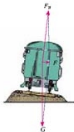
图5.8-3 外轨高于内轨时，重力 G 与支持力 F_N 的合力 F 是使火车转弯的向心力。
