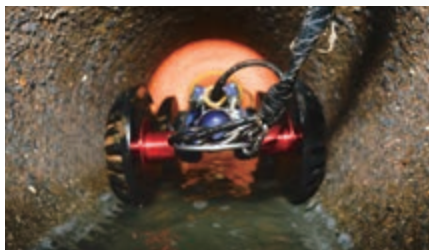
机器人在下水道里探测水下管网
