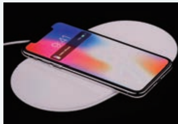
图3.3-4 对移动电话进行无线充电
