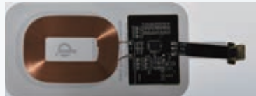
图3.3-5 无线充电接收器中的线圈
