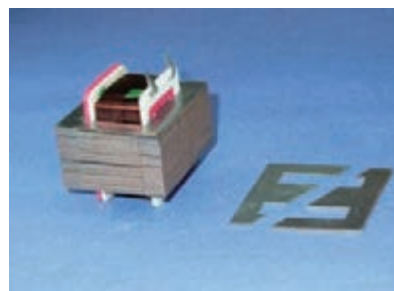
图 2.3-5 用硅钢片做变压器的铁芯
