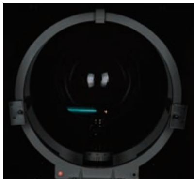
图 1.3-3 没有磁场时电子束沿直线运动
