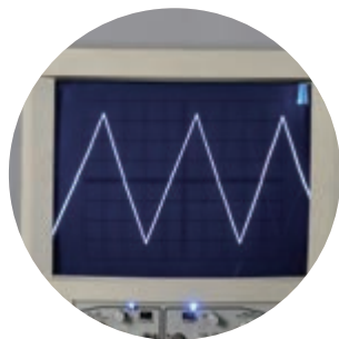
乙 示波器中的锯齿形扫描电压
