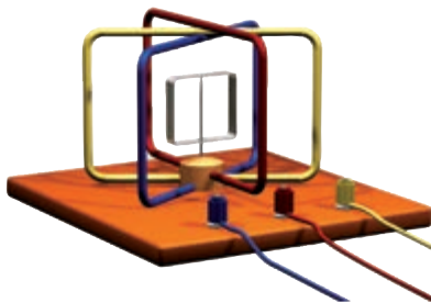
图 2.3-11 产生旋转磁场的装置
