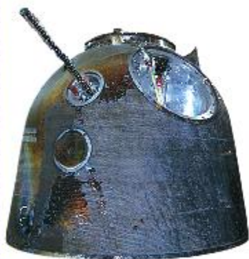
图 5-9 宇宙飞船返回舱烧蚀后外壳
