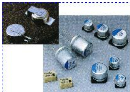
图 5-23 用导电高分子材料制成的电子器件
