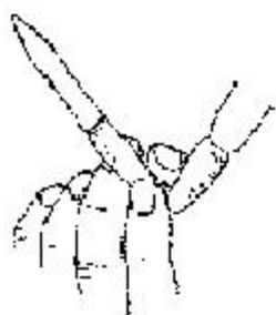
图 3-12 除去碱式滴定管胶管中气泡的方法
