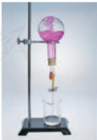
图5-11 氨溶于水的喷泉实验
