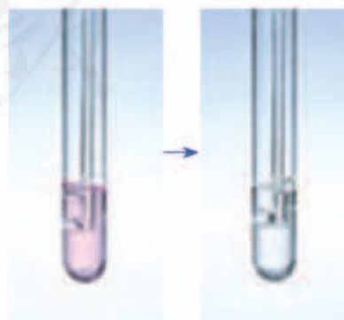
图7-10 乙烯与高锰酸钾反应
