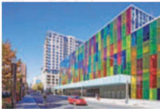
图5-21 金属氧化物可以使玻璃呈现不同的颜色
