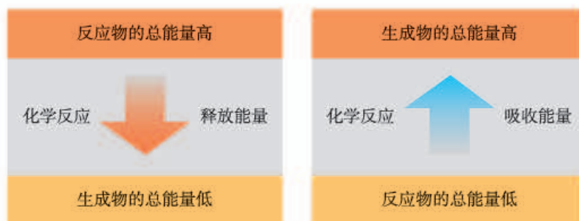
图6-3 化学反应与能量变化的关系示意图
