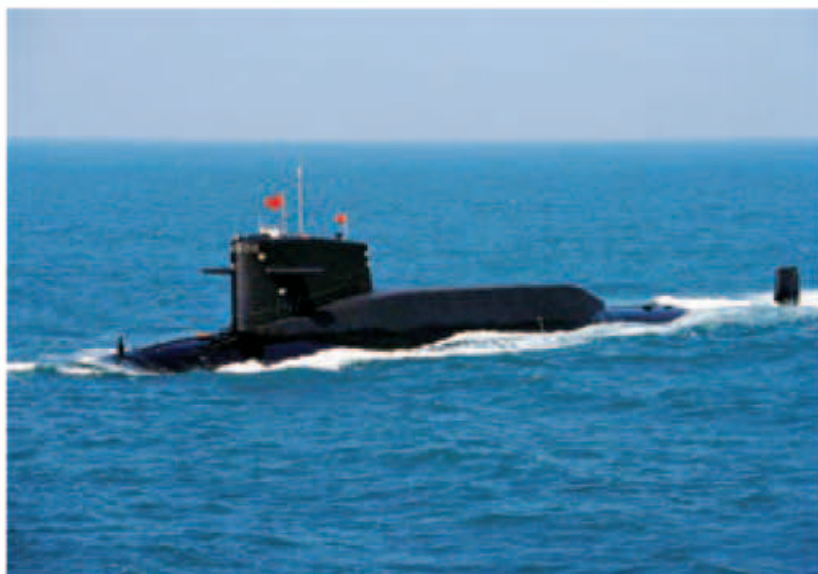
图7-15 橡胶消声瓦可有效降低潜艇航行时的噪声，提高潜艇的隐蔽性
