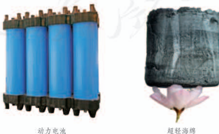
图5-31 使用了石墨烯材料的动力电池和超轻海绵
