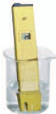
图5-17 用pH计测量水样的酸度
