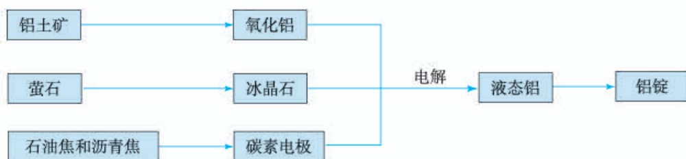
图8-1 铝的生产原理示意图
