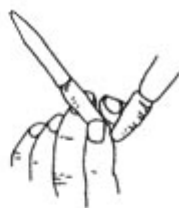
图 3-11 除去碱式滴定管胶管中气泡的方法
