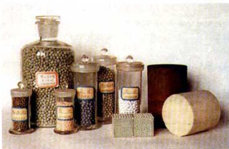
图 2-18 净化汽车尾气的 催化剂及其载体
