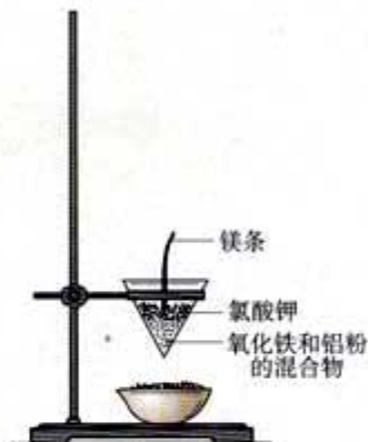
图 4-1 铝热反应的实验装置
