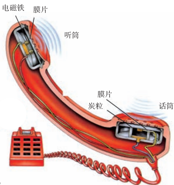
图 21.1-3 电话结构示意图
