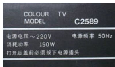
图18.2-2 多数用电器都有类似的铭牌，从中可以查到这个用电器的电功率。大型用电器的电功率可以从说明书中查得。
