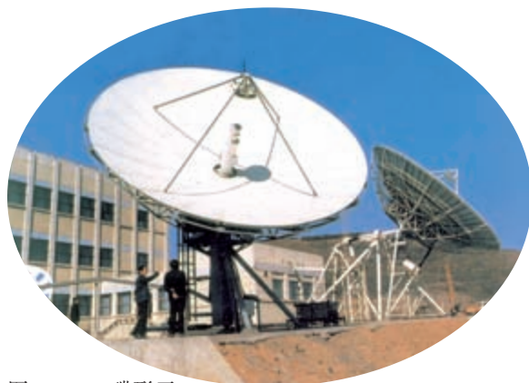
图21.4-4 碟形天线用来接收来自卫星的信号
