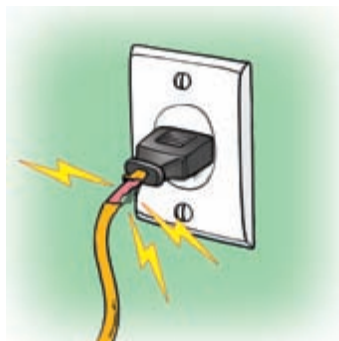
图 19.2-2 绝缘皮破损容易造成短路
