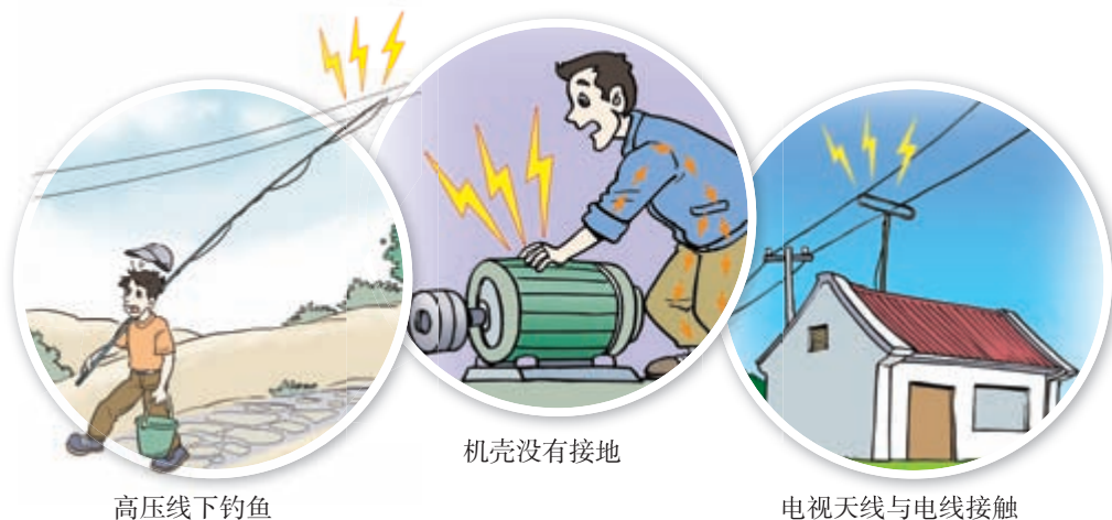
图 19.3-4 几种容易引起触电的情况
