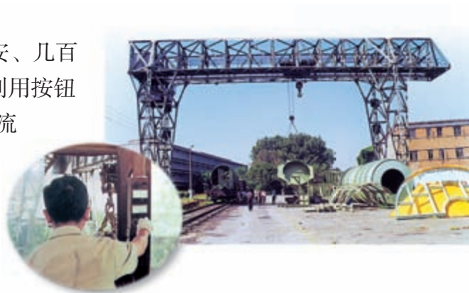
图 20.3-4 工人师傅手中的按钮只是继电器的开关
