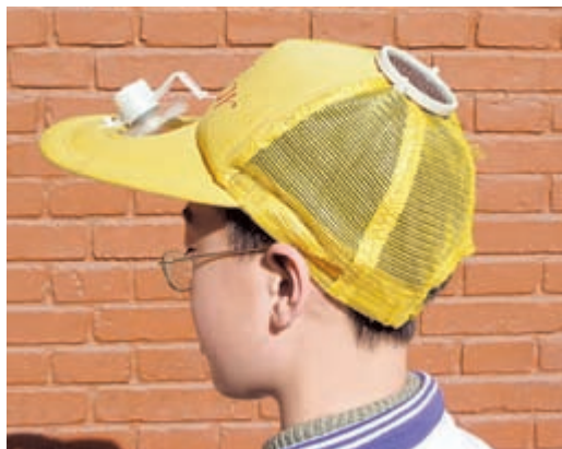
图22.3-6 太阳能凉帽。电池板把太阳能转化为扇叶的动能。
