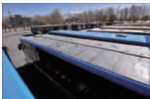
图6-93 安装太阳能板的公交车
