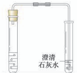
图 11-4 碳酸钠与盐酸反应的装置
