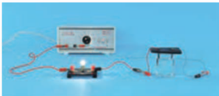
图 10-9 试验物质的导电性
