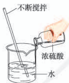
图 10-5 浓硫酸稀释的正确操作
