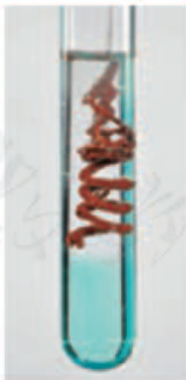
图8-13 铝与硫酸铜溶液的反应
