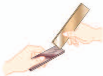
图8-5 比较合金和纯金属的硬度
