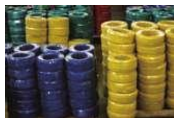
电线外面的绝缘层是 聚氯乙烯塑料
